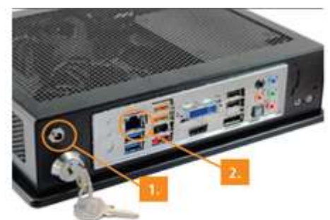
9Solutions HACCU: 1. Netzkabel Anschluss 2. Ethernet Kabelanschluss
