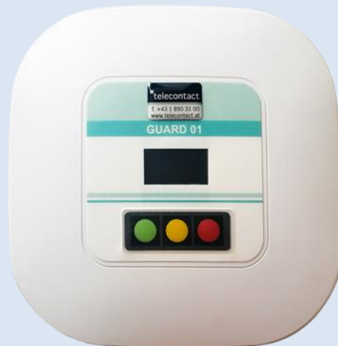
Telegate Guard 01 - Türwächter RFID-Lesegerät erkennt Arbandsender
