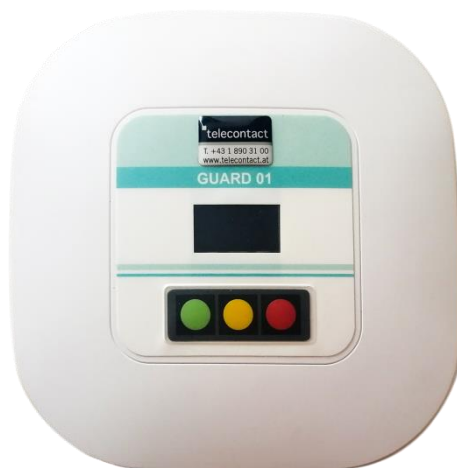
Telegate Guard 01 - Türwächter RFID-Lesegerät erkennt Arbandsender
